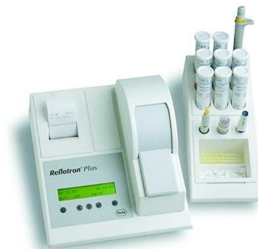
Figura 2: Equipamento utilizado para análise do parâmetro bioquímico de dano muscular: Reflotron® Plus.
